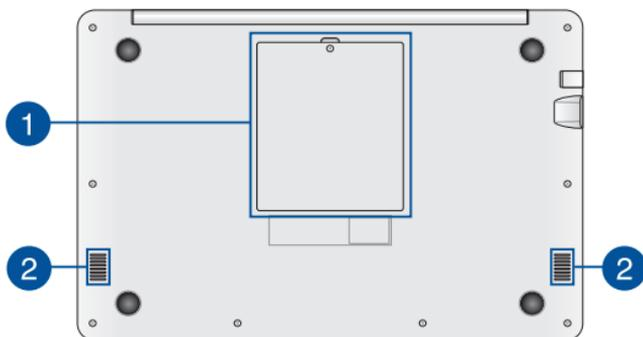
**1 Compartiment pour disque dur (sur une sélection de modèles)**
