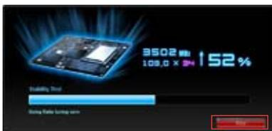
5. TurboV ajuste et enregistre automatiquement les réglages du BIOS puis redémarre le système. À la prochaine ouverture de session Windows, un message apparaîtra pour indiquer que le processus d'overclocking automatique a réussi. Cliquez sur **OK** pour quitter.
