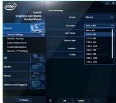
4. Vous pouvez aussi cliquer sur **Display** (Affichage) > **General Settings** (Paramètres généraux) > **Scaling** (Mise à l'échelle) > **Customize Aspect Ratio** (Personnaliser le format d'image). Déplacez les curseurs de mise à l'échelle puis cliquez sur **Apply** (Appliquer).
