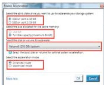
**Maximized mode** : écriture sur le disque SSD dans un premier temps, puis écriture sur le disque dur (HDD) ultérieurement.
