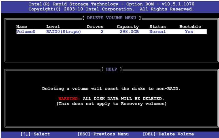
2. Utilisez les flèches haut-bas pour sélectionner le volume RAID à supprimer, puis appuyez sur <Suppr>. Le message d'avertissement suivant apparaît.
