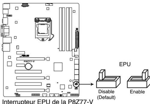
Interrupteur EPU de la P8Z77-V
