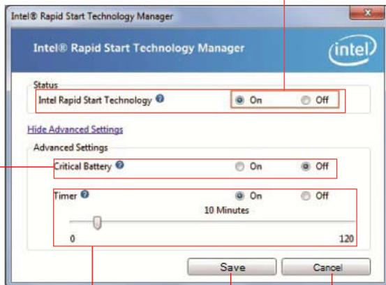
Active ou désactive le minuteur. Si activé, déplacez le curseur sur la valeur désirée. Lorsque le système est inactif pendant une période supérieure au délai spécifié, celui-ci basculera automatiquement en mode Intel® Rapid Start. La valeur par défaut est de 10 minutes.
