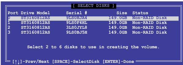
5. Utilisez les flèches haut-bas pour mettre un disque en surbrillance, puis appuyez sur <Espace> pour le sélectionner. Un petit triangle distinguera ce disque. Appuyez sur <Entrée> pour terminer votre sélection.
