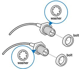
2. Passez le connecteur au travers l'ouverture dédiée à la prise antenne de la plaque d'E/S.
