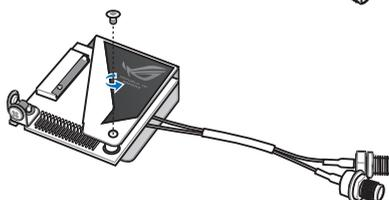
3. Alignez et insérez le module SSD M.2 (NGFF) dans son interface de connexion.
