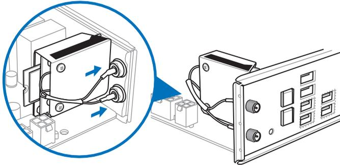
3. Remplacez le boulon sur le connecteur.
