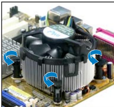
3. Retirez les attaches deux par deux, en suivant une séquence diagonale, afin de libérer l'ensemble ventilateur-dissipateur de la carte mère.
