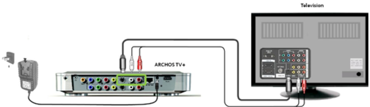
*\* Amérique du Nord : si votre téléviseur ne possède pas de connexion d'entrée S-Vidéo, utilisez un câble vidéo RCA mâle/mâle standard (prise vidéo jaune) au lieu du câble S-Vidéo fourni.*
